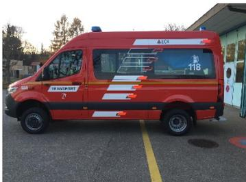
MIKA 380, Mercedes Benz 516 CDI 4x4, véhicule transport de personnes et matériel, fourni par l'ECA avec 1 container inondation et 1 container éclairage, en remplacement de MIKA 65, première génération des TPM.
